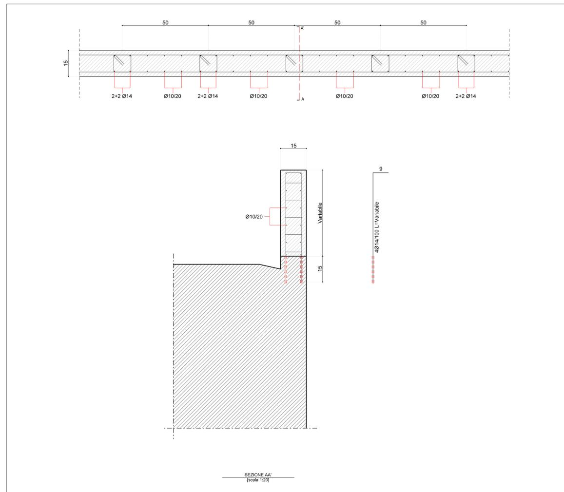
DETTAGLIO 3: INNALZAMENTO MURO IN C.A.
