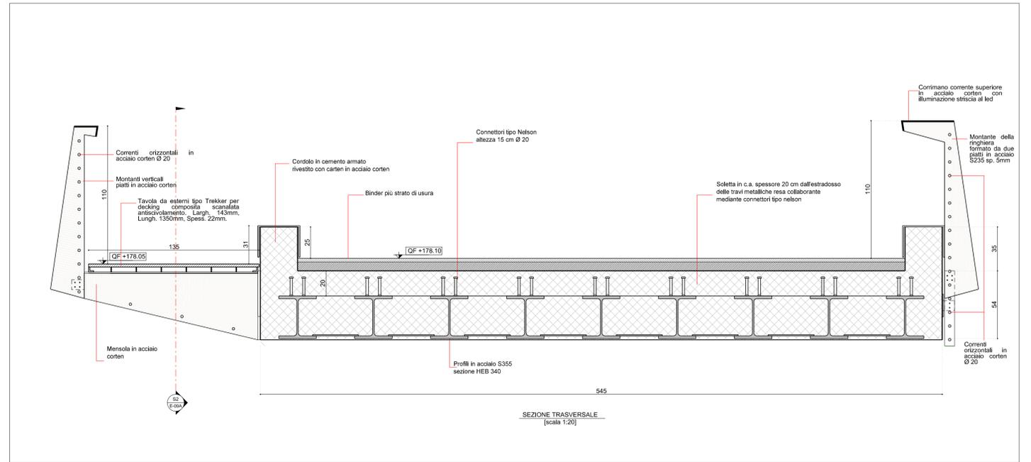
DETTAGLIO 2: SEZIONE TRASVERSALE PONTE
