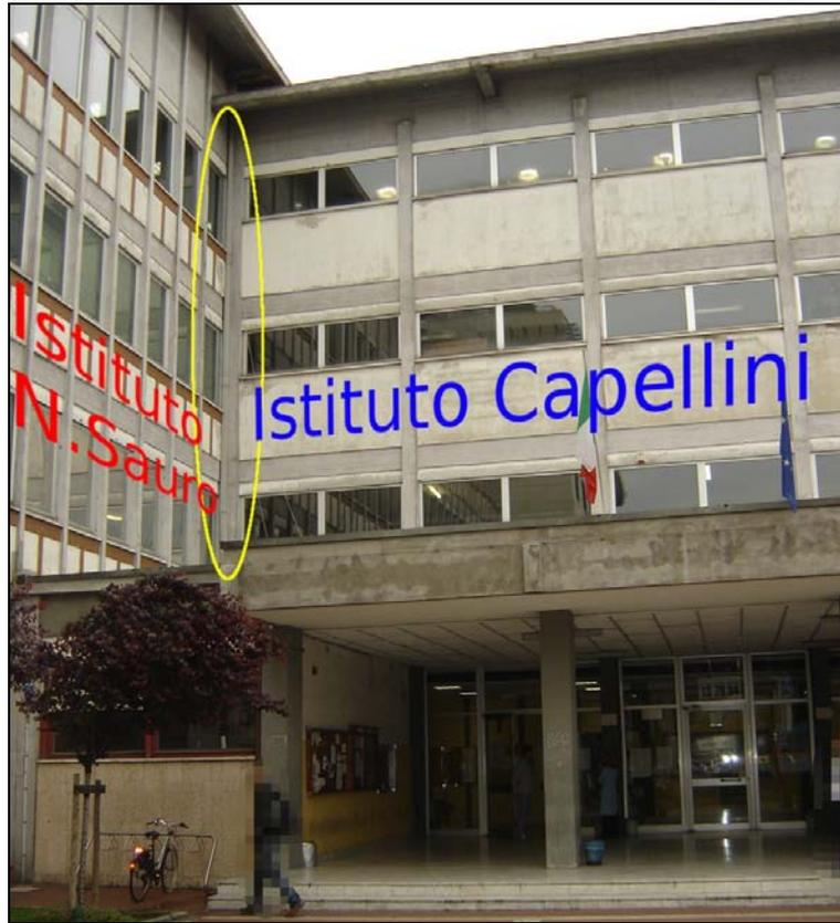
**Fig. 3-7 . Istituto N. Sauro, a sinistra, ed istituto Capellini, a destra: in evidenza l'assenza di giunto strutturale tra i due corpi di fabbrica e la conseguente continuità strutturale.**
