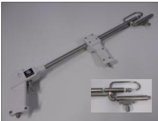
Figura 1: Esempio di pre-diluitore dinamico
