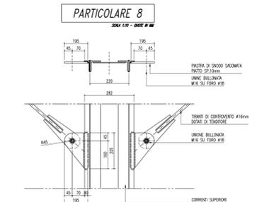
SISTEMA DI AGGANCIO TIRANTI IN ACCIAIO SU STRUTTURA IN ACCIAIO - CONTROVENTI INCLINATI
